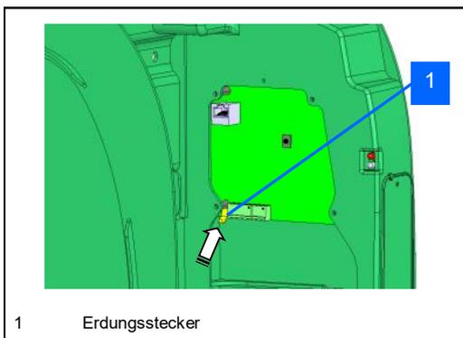
• Halten Sie das Erdungskabel mit der Kabelklemme fest an der Metallsäule. Das Kabel darf nicht am Kabelschuh ziehen.
